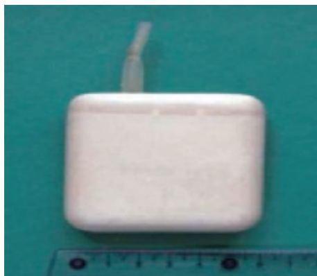
Sl. 1. Prvi srčni spodbujevalnik vstavljen v Ljubljani 16. 4. 1965. Dimenzije: 6,4 × 7,2 × 2 cm.
